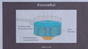
Gambar 2.2 Perpindahan Kalor Secara Konveksi
