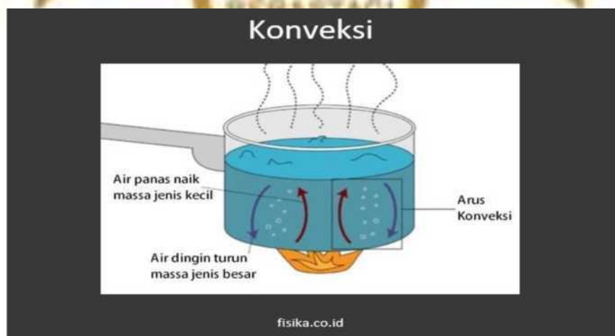
Gambar 2.2 Perpindahan Kalor Secara Konveksi
