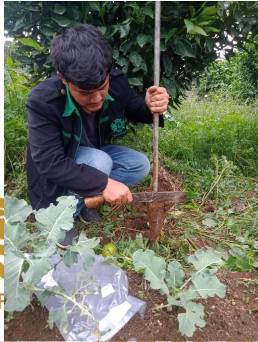
Gambar 2. Mengambil Sampel dari Bor
