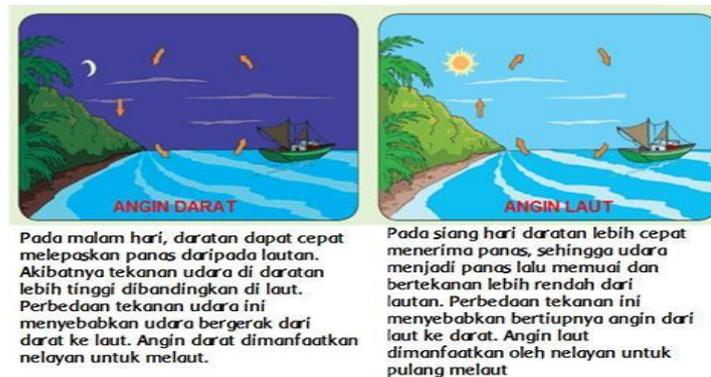
Gambar 2.3 perpindahan kalor secara konveksi
